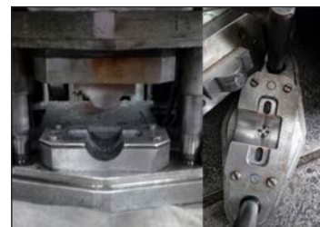
Рис. 7. Восстановленная матрица в штампе
