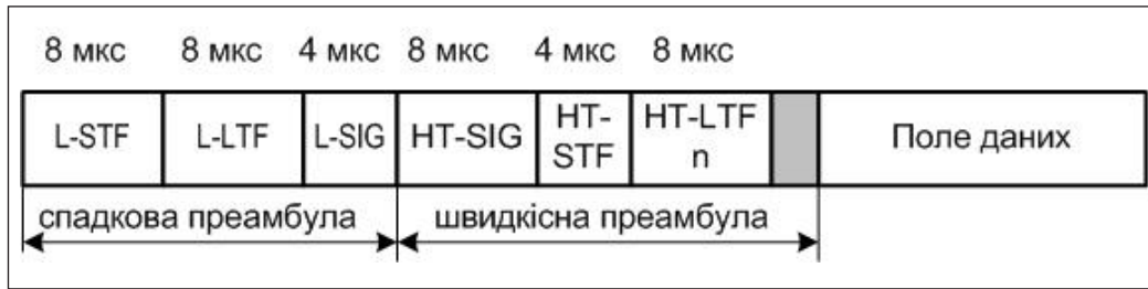
Рис. 3. Структура преамбули кадру фізичного рівня у змішаному режимі
