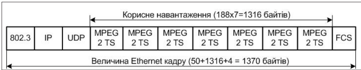
Рис. 1. Структура IP пакета відеопотоку в мережі Ethernet
