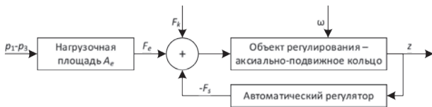
Рис. 6. Модель импульсного уплотнения как системы автоматического регулирования
