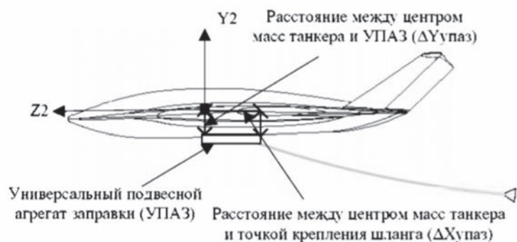
Рис. 2. Розташування танкера і заправляемого БЛА (БЛА «Global Hawk») під час дозаправки
