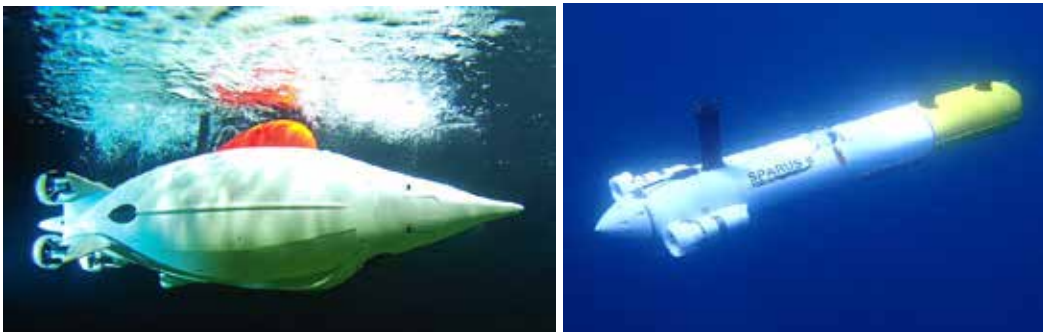
Рис. 1. Зовнішній вигляд АНПА з винесеним поза корпус РКП: а – АНПА «PingGuin» (Німеччина); б – АНПА «Sparus II» (Іспанія)
