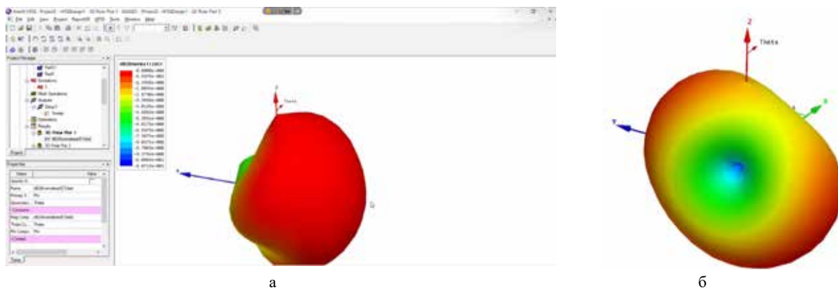
Рис. 5. Простора діаграма спрямованості (а) та 3-D зображення просторової діаграми спрямованості (б) гнучкої антени LTE
