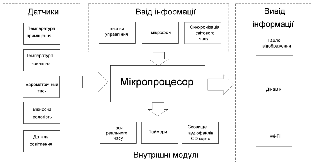
Рис. 6. Структурна схема функціоналу годинника
