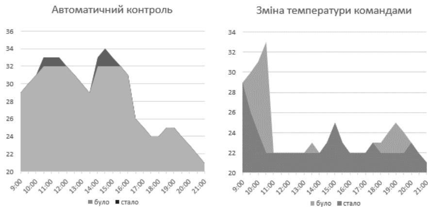
Рис. 3. Результати тестування IoT-бота: а) робота чатбота в автономному режимі; б) керування температурою згідно команд користувача
