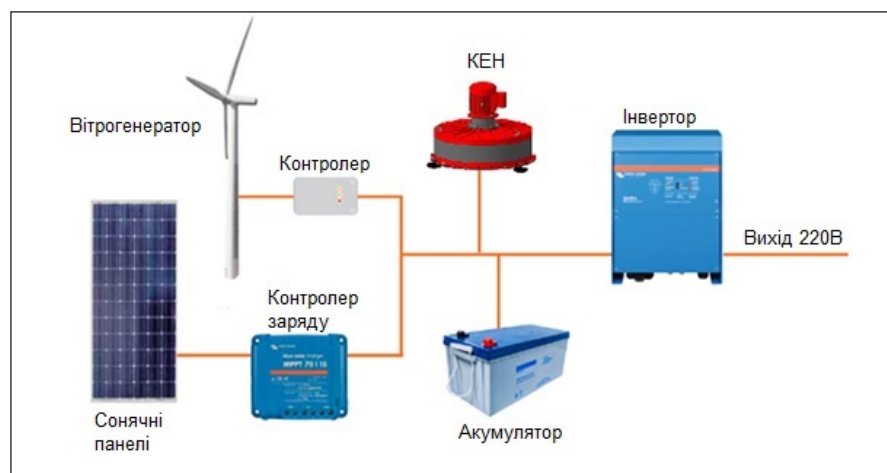
Рис. 3. Структурна схема автономного електропостачання зі змішаними типами накопичувачів енергії
