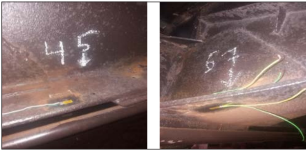
Рис. 2. Місця встановлення тензорезисторів на несучих елементах дослідного напіввагона
