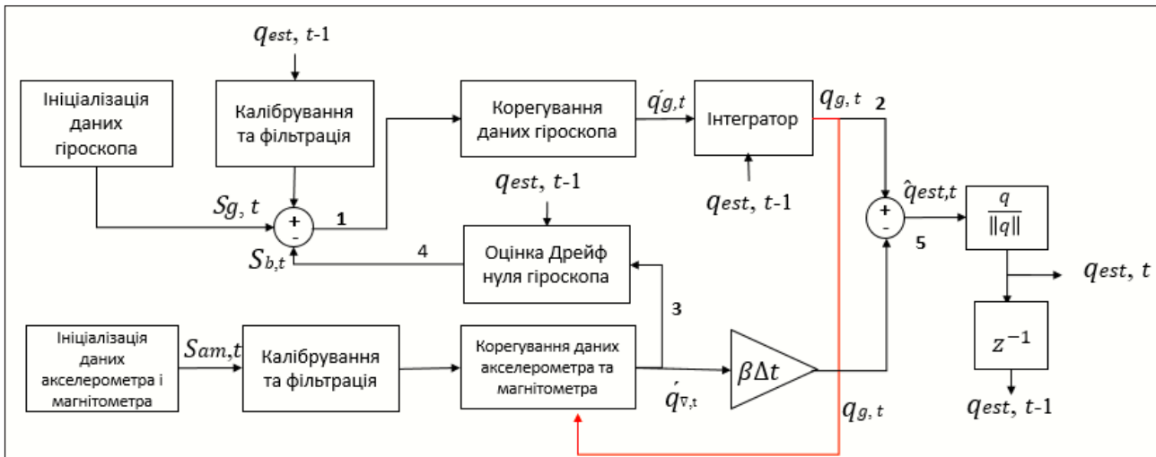
Рис .1. Блок-схема представляє фільтр ІНС із магнітометром, акселерометром і гіроскопом
