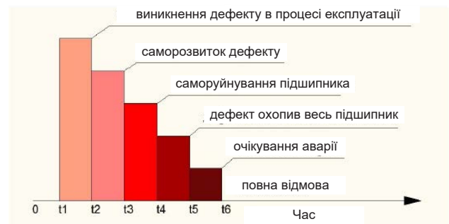
Рис. 5. Стадії розвитку дефекту підшипника в часі
