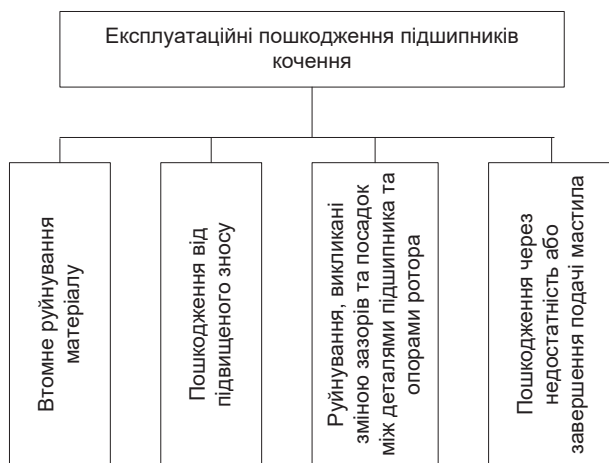
Рис. 3. Схема експлуатаційних пошкоджень підшипників кочення
