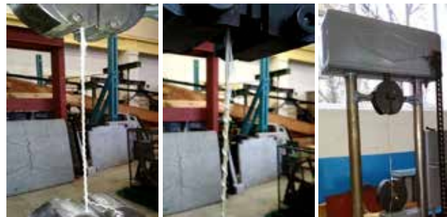
Рис. 13. Загальний вигляд випробувань зразків із склопластикової арматури
