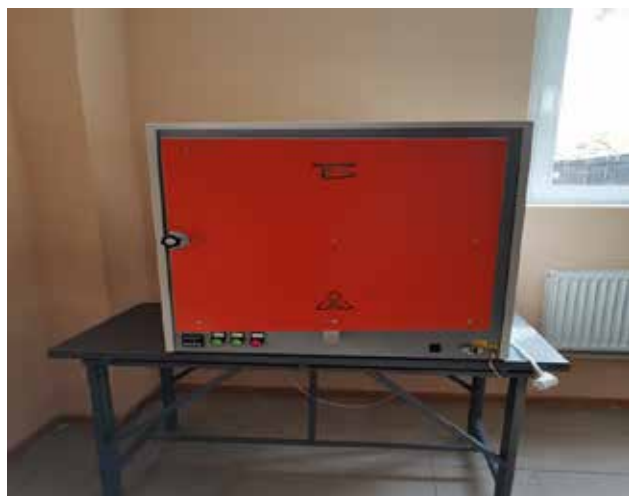
Рис. 5. Зовнішній вигляд термошафи з горизонтальною циркуляцією повітря
