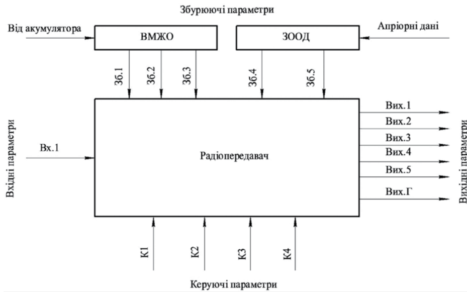
Рис. 2. Радіопередавач як об'єкт оптимізації ВМЖО – відсутність мережі живлення на обортовому об'єкті; ЗООД – апріорні дані, зв'язані з обортовим об'єктом
