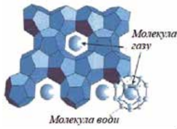
Рис. 1. Зображення структури газогідрату (клатрату)
