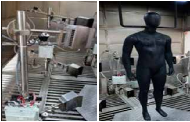
Рис. 2. Загальний вигляд манекену, оснащеного засобами виміральної техніки
