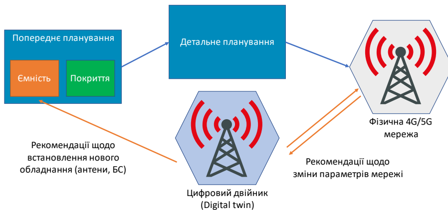
Рис. 2. Інтеграція цифрового двійника радіомережі в процеси планування та оптимізації
