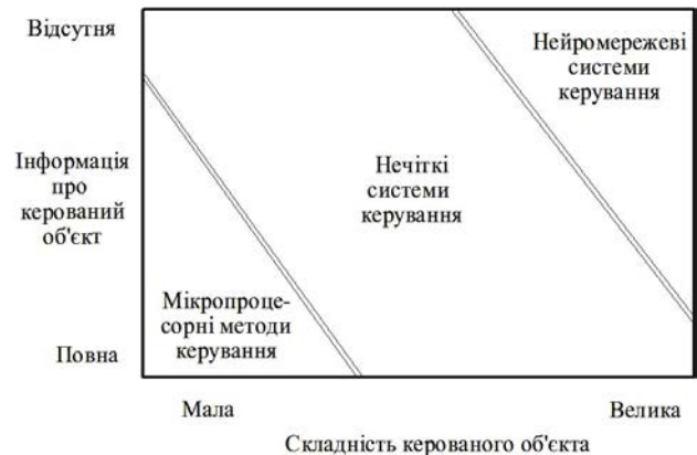
Рис. 5. Области різних технологій реалізації систем керування, де вони ефективно застосовуються
