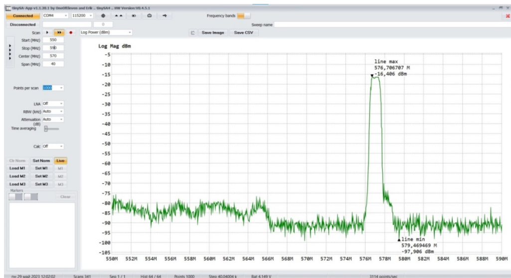
Рис. 8. Спектр вологочутливого перетворювача на основі мікроелектронного автогенераторного приладу з використанням в якості первинного перетворювача вологості польового транзистора з індукованим каналом при вологості 50% та температурі 20 °C
