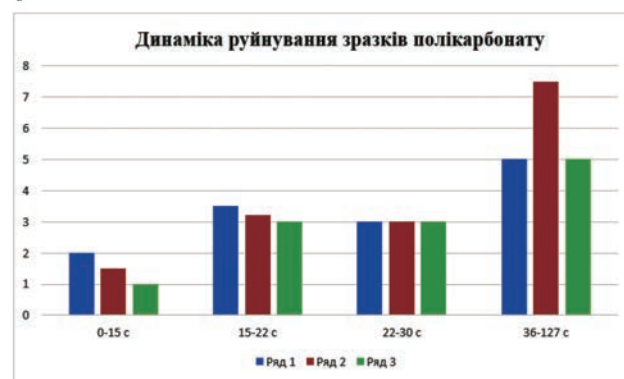
Рис. 1. Калібрувальна шкала руйнування полікарбонату під термічним впливом [побудовано автором]
