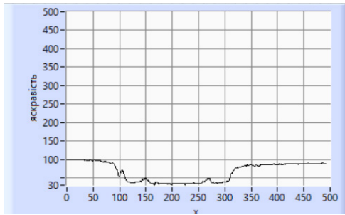
Рис. 2. Профіль яркості зображення формування газових розрядів навколо зразка води з домішками нафтопродуктів
