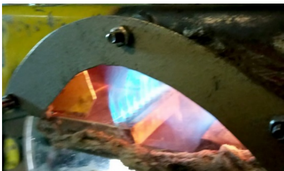
Рис. 8. Горіння палива з домішками водню в струменево-нишевому модулі
