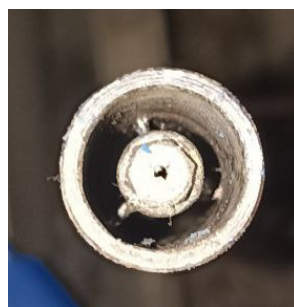
Рис. 5. Комбінований газо-мазутний струменево-нишевий паливковий прилад
