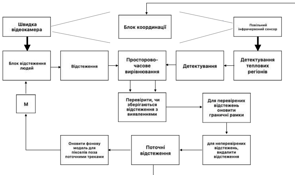
Рис. 3. Структурна схема системи відстеження людей згідно [7]
