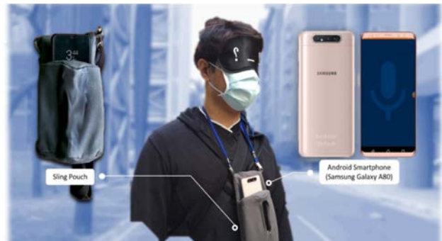
Рис. 1. Система допомоги при пересуванні людей з вадами зору за допомогою смартфона на базі Android (праворуч) та слінг-сумки (ліворуч)
