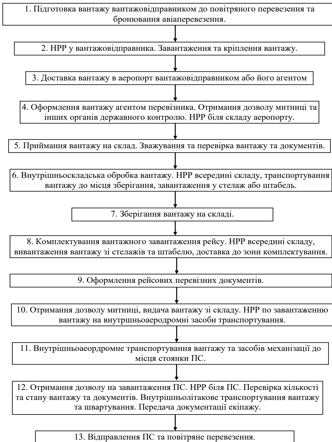
Рис. 1. Технологічна схема авіаперевезення вантажів на відправлення
