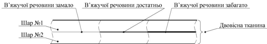
Рис. 4. Багатовісна тканина з різною кількістю в'язучої речовини
