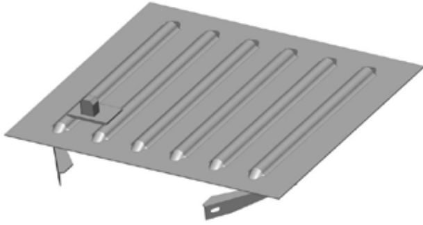
Рис. 2. Просторова модель кришки люка з фітинговим упором
