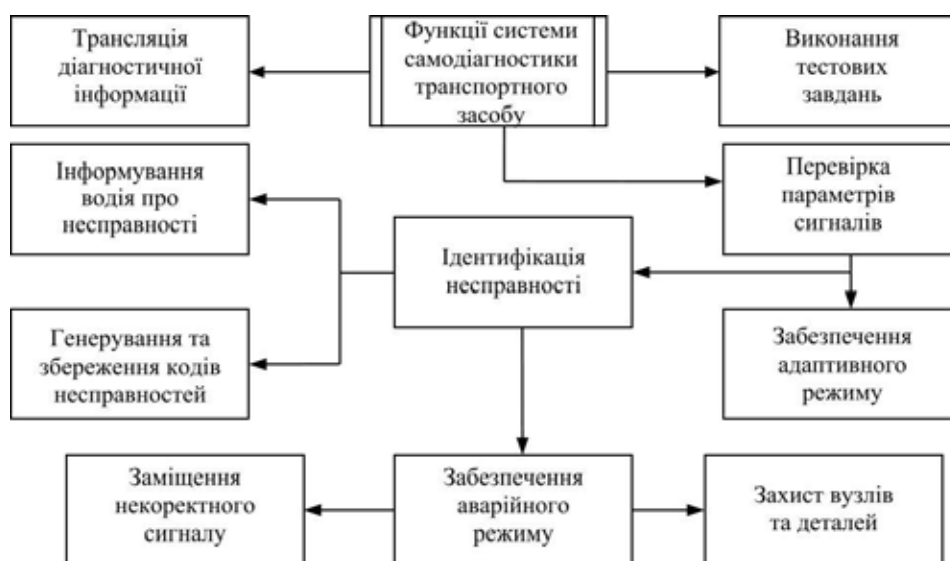
Рис. 1. Функції бортової системи самодіагностики транспортного засобу [7, с. 168]
