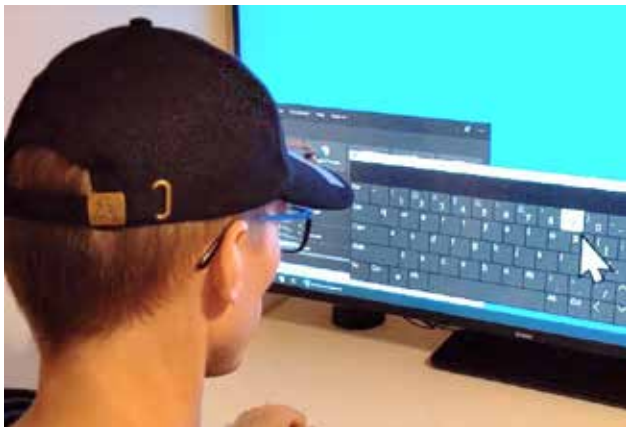
Рис. 2. Приклад роботи “Head mouse”
