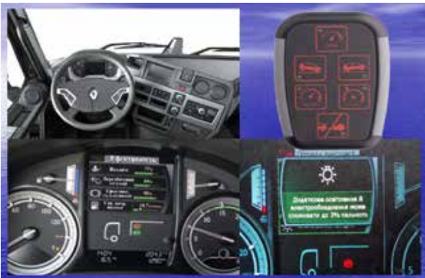
Рис. 2. Вбудовані системи контролю технічного стану та оцінки майстерності водія вантажного автомобіля марки Renault
