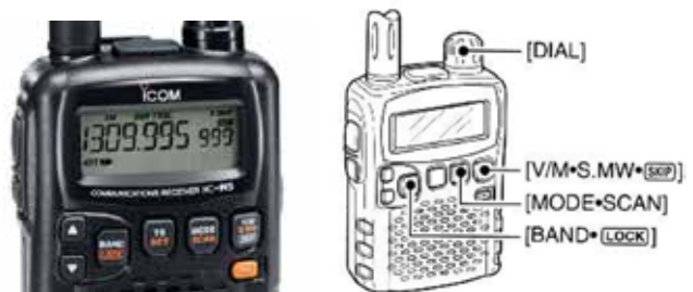
Рис. 6. Розміщення органів керування скануючого радіоприймача ICOM IC-R5 [10]
