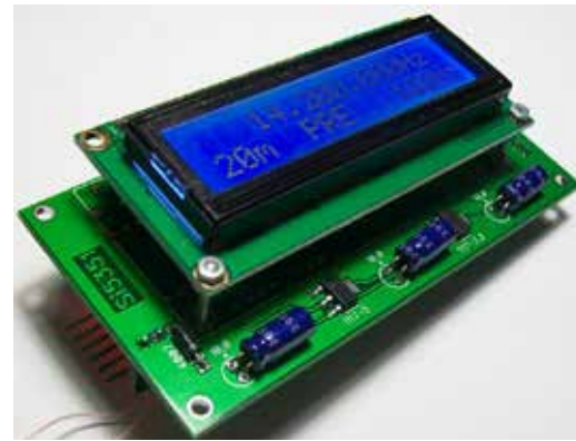
Рис. 5. Універсальний радіоаматорський синтезатор частоти на базі Si5351
