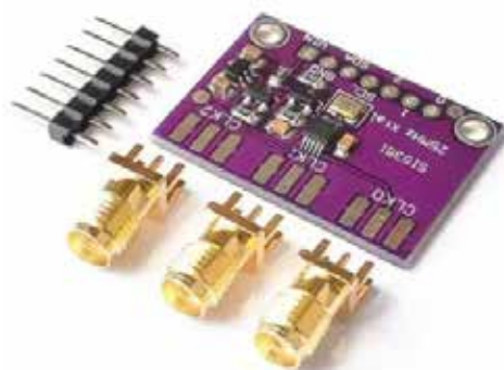
Рис. 4. Відлагоджувальні плати, у яких використовуються мікросхеми-клони синтезатора частоти Si5351
