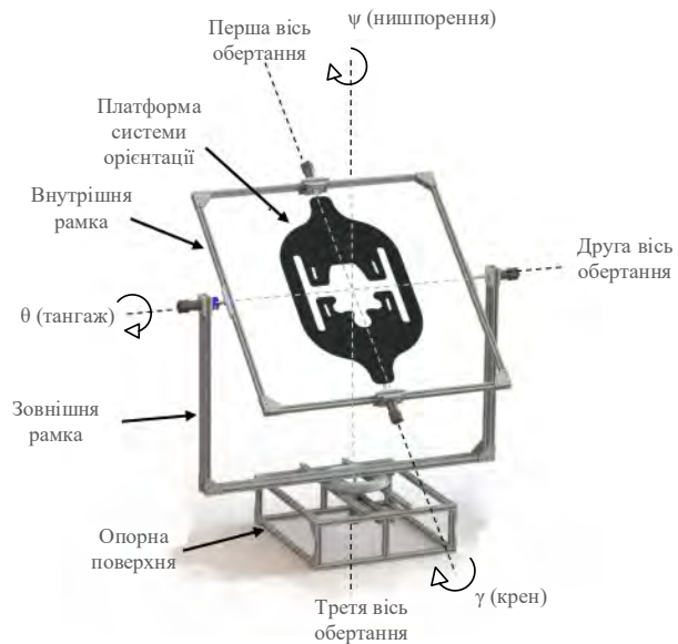
Рис. 2. Конструкція карданного підвісу
