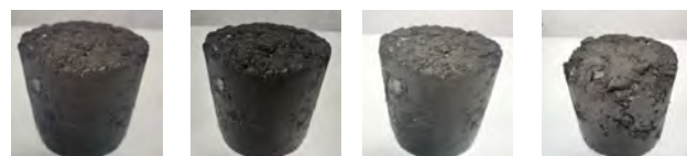
Рис. 13. ЩПС. КР. Ц (II) із залізистих кварцитів, укріплених 4 % цементу
