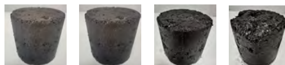
Рис. 14. ЩПС. КР. Ц (II) із залізистих кварцитів, укріплених 6 % цементу
