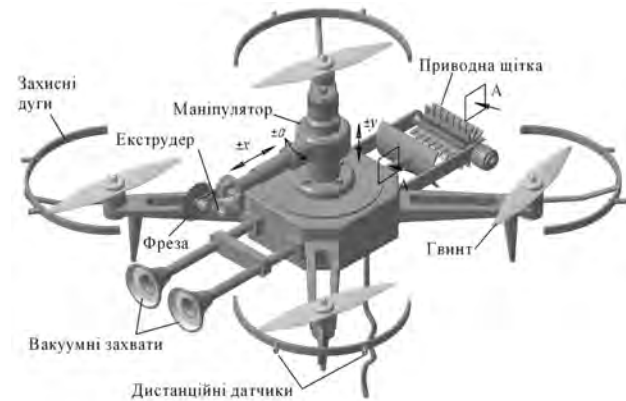
Рис. 2. Квадрокоптер для обслуговування вертикальних труб
