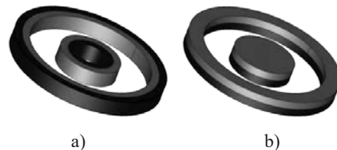
Рис. 13. Можливе розташування кілець постійного магніту, які використовуються для налаштування системи. Зовнішнє кільце кріпиться до щогли (осцилятор), а внутрішнє кільце кріпиться до основи (статор) [7]
