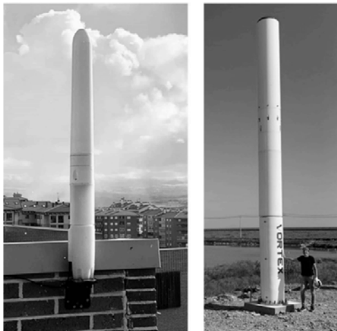
Рис. 3. Vortex Nano висотою 0,85м (а), Vortex Atlantis висотою 9м (б) [8]
