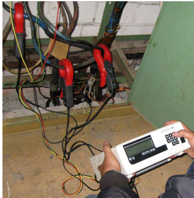
Рис. 1. Прилад Ресурс-UF2М для моніторингу показників якості електроенергії
