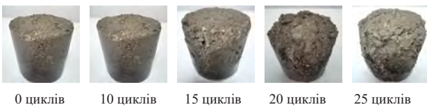
Рис. 18. ЩПС.Кр.Ц (II) із гранітних мінеральних матеріалів, що укріплені 4 % цементу
