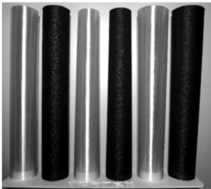
Рис. 4. Прототипи щогли зліва направо: циліндр, розбіжний конус (оригінальна модель) і збіжний конус. Світлий колір – прототипи з гладкою поверхнею, темний – з шорсткою (висота нерівностей 0,3 мм, відстань між ними – 0,8 мм) [8]
