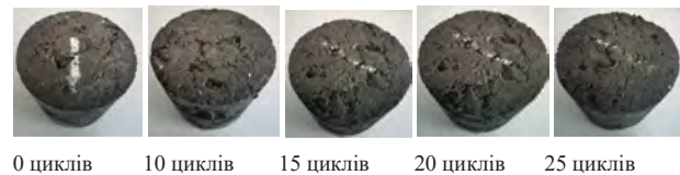
Рис. 3. ЩПС.Кр.Ц(I) із залістистих кварцитів, укріплених 4 % цементу
