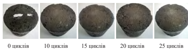
Рис. 5. ЩПС. Кр. Ц (I) із залістистих кварцитів, укріплених 8 % цементу
