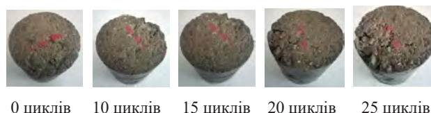
Рис. 10. ЩПС. Кр. Ц (I) із гранітних сумішей, укріплених 8 % цементу
