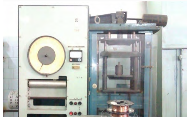
Рис. 3. Лабораторна установка для пресування порошоків [світлина зроблено авторами]
