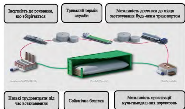
Рис. 6. Відмінні особливості флексі-танків для небезпечних вантажів
