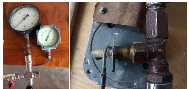
Рис. 5. Фото зібраного кавітаційного вузла з манометрами для вимірювання
